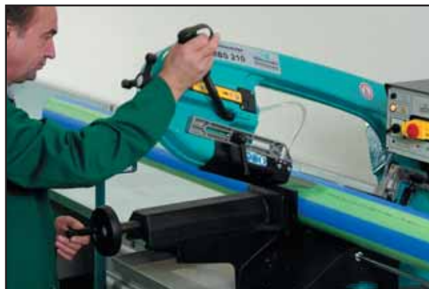
Prije postupka zavarivanja slijedi odrezivanje cijevi Ø 160 na željenu dužinu.
