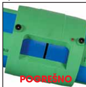
Za optimalan, stabilan rezultat zavarivanja, preporučamo oba kraja cijevi unutar E-spojnice položiti međusobno planparalelno. Bezuvjetno pripaziti na najmanje dubine zavarivanja.
